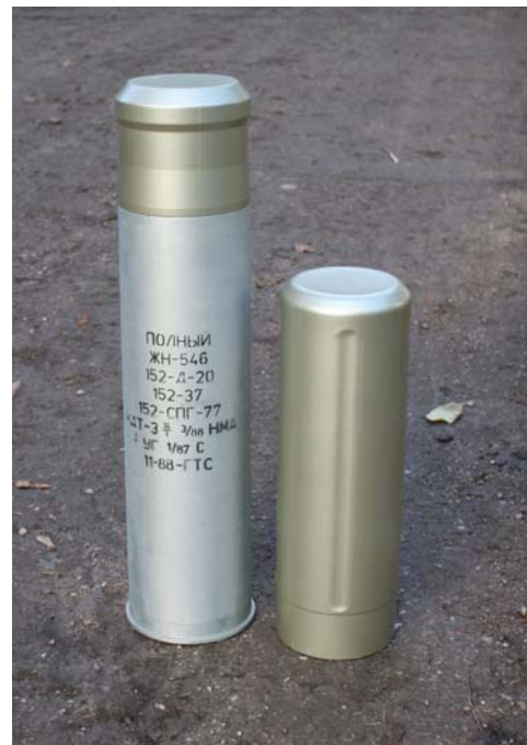
Ocelová nábojka pro ráži 152 mm s vloženým modulem a zesilovacím modulem
