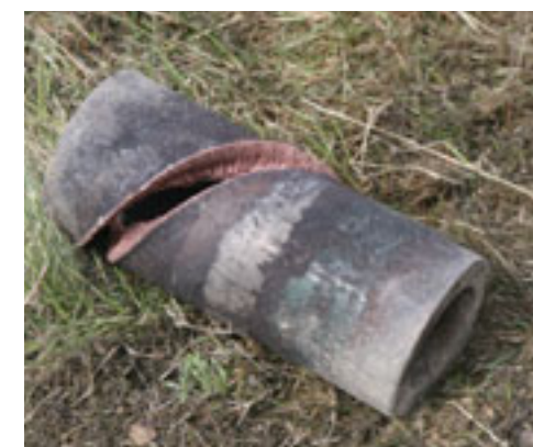
SEMTEX Razor před explozí na silnostěnné trubce a silnostěnná trubka po explozi
