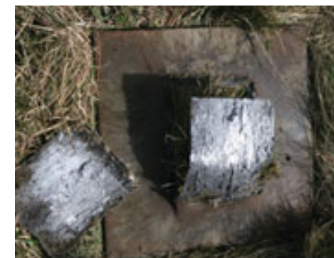
SEMTEX PI SE M listová nálož před explozí
