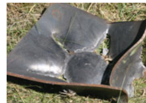
SEMTEX PI SE M pásková nálož před explozí a po explozi
