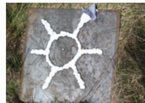
SEMTEX PI SE M pásková nálož před explozí a po explozi
