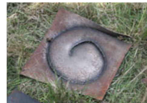
SEMTEX PI SE M pásková nálož před explozí a po explozi
