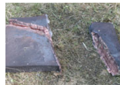
SEMTEX Razor před explozí na ocelové desce a ocelová deska po explozi
